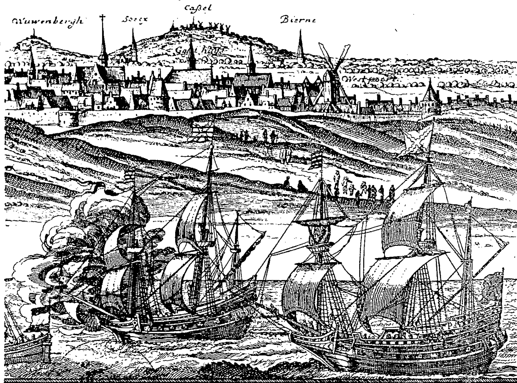
Frégates pénétrant dans le port de Dunkerque par la fosse de Mardyck. — (Autre fragment de la même planche). On remarquera que ces frégates sont grées comme de petits vaisseaux : deux mâts portant des voiles carrées et un artimon. Elles n'ont pas de focs. L'une d'elles est pourvue d'une civadière.
